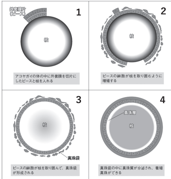
図10 真円真珠ができるしくみの模式図 『海洋教育カリキュラム集① 三浦真珠編』より
