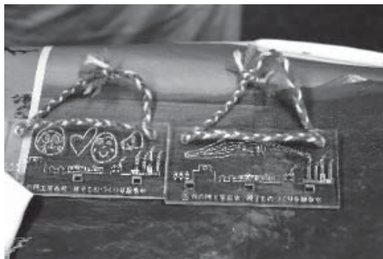
写真2 レーザー加工後のアクリル板
